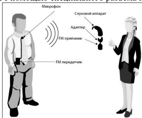
Рис. 6. Схема работы FM-системы
