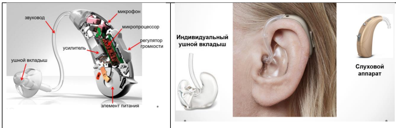
Рис. 2. Слуховой аппарат заушного типа с индивидуальным полным ушным вкладышем.
